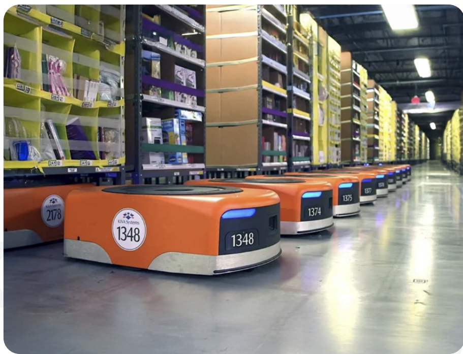
Robots logísticos de Amazon Robotics en acción dentro de un centro de distribución. Estos sistemas automatizados forman parte de su infraestructura AS/RS; permiten el almacenamiento y recuperación eficiente de productos. Fuente: Scallog. 48
